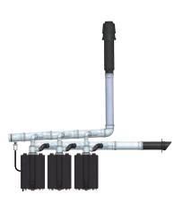
SIDE WALL INTAKE VERTICAL **EXHAUST** CU199 ONLY
